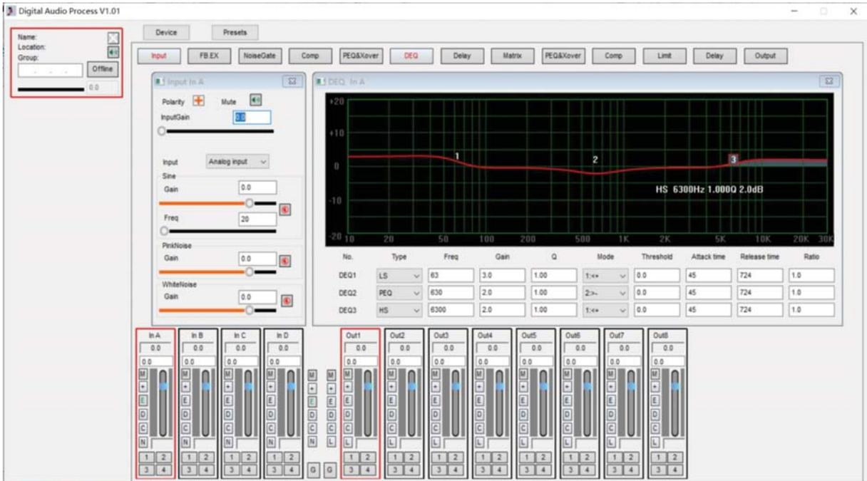
PC 소프트웨어는 네트워크를 통해 단일 또는 여러 온라인 장치를 구성하고 관리 할 수 있습니다. 장치 매개 변수를 장치 또는 컴퓨터 파일에 저장할 수 있습니다. 최대 250 개. 실시간 전환 및 편집을 용이하게 하기 위해 동시에 온라인 상태로 편집할 수 있습니다. 파라미터 편집, 그룹핑 및 링크는 사용자가 빠르게 설정할 수 있어 매우 편리합니다.
